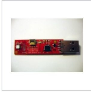
🔴 SiLabs Si7005USB- Dongle (USB)
