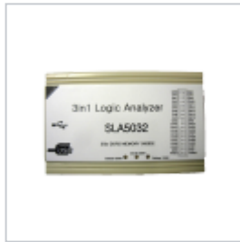
✓ Sysclk SLA5032 (32ch, 500MHz)
