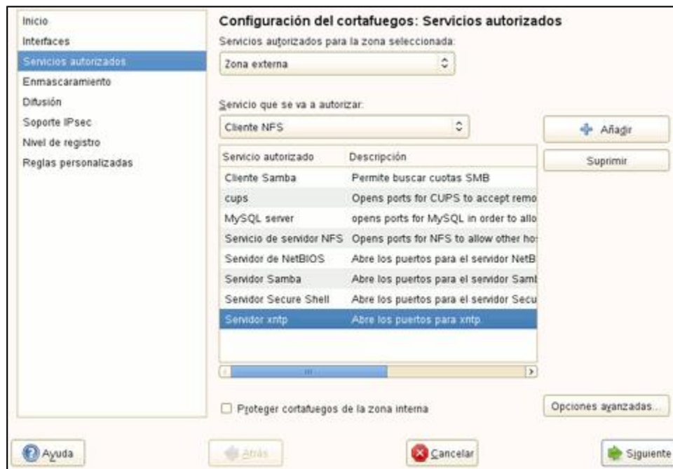
Módulo de cortafuegos de YaST, en modo gráfico, habilitando servidor xntp.
