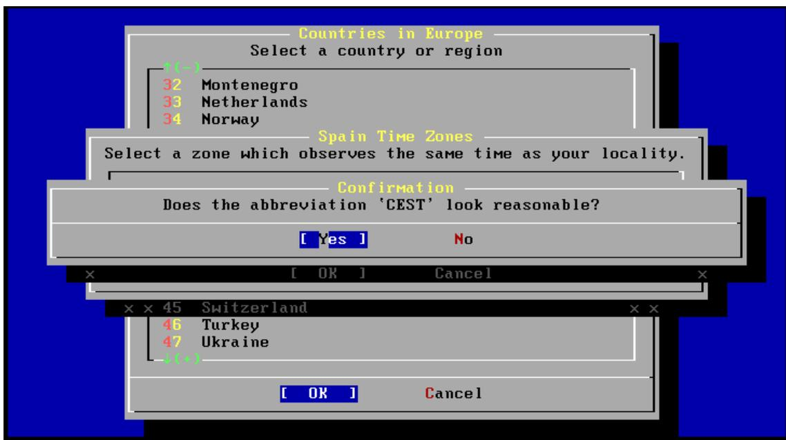
14. Ahora para finalizar la configuración horaria, el Sysinstall te pedirá que le confirmes todas las elecciones que has realizado. Con TAB, te sitúas en OK, y pulsas [ENTER].
