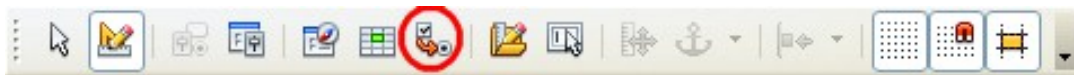
Figura 207: barra de herramientas Diseño de formulario con el icono Secuencia de activación marcado
